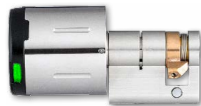
6126 Knaufmodul als Halbzylinder mit elektronischer Berechtigung für den Innenbereich mit Federrückstellung und abgeschrägter Schließnase.
