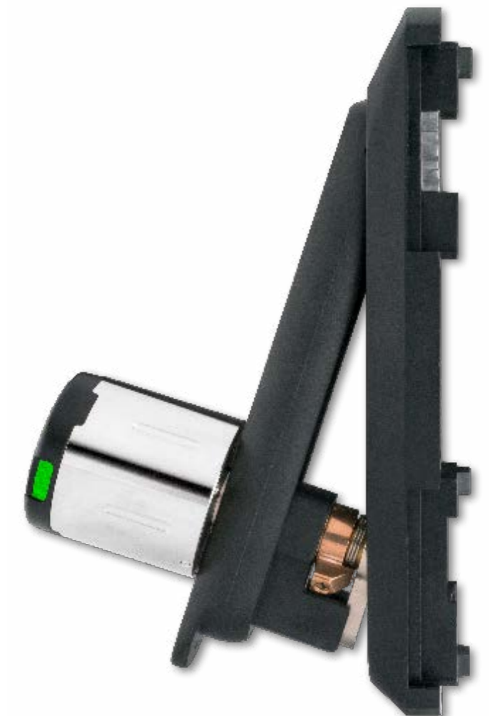
2126 Knaufmodul als Halbzylinder mit elektronischer Berechtigung für den Innenbereich mit Federrückstellung und abgeschrägter Schließnase eingebaut in ein Serverschloss mit Schwenkhebel.
