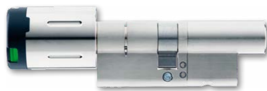
8162SP Kompakter Doppelknäufzylinder mit einseitiger elektronischer Berechtigung/Antipanic-Variante mit mechanischem Schlüssel. Für den speziellen Anwendungsbereich in Bestands-Notausgangstüren.
