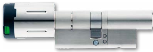
2162SP Kompakter Doppelknopfzylinder mit einseitiger elektronischer Berechtigung/Antipanic-Variante mit mechanischem Schlüssel. Für den speziellen Anwendungsbereich in Bestands-Notausgangstüren.
